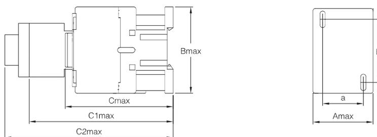
CFC3s-40~95外形及安装尺寸图
