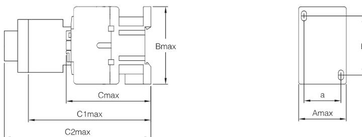
CFC3s-25~32外形及安装尺寸图
