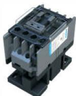
CFC3s系列交流接触器(以下简称接触器),主要用于50Hz,额定电压至660V/690V,在AC-3使用类别下额定工作电压为380V/400V时额定工作电流至95A的电路中,供远距离接通和分断电路之用,并可适当的过热过载继电器组成电磁起动器以保护可能发生操作过负荷的电路,接触器适宜于频繁地起动。
